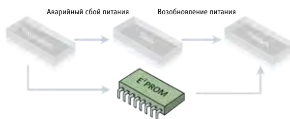
Настройки сохраняются на случай аварийного сбоя электропитания.
