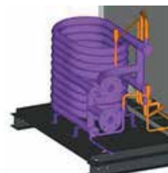
Испаритель типа «труба в трубе»
