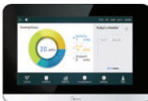
CCM-180A/WS – центральный контроллер последнего поколения для систем Midea V6. Сенсорный экран 6,2 дюйма. Подключение к VRF осуществляется через порты M-net. CCM-180A поддерживает одновременно до 8 систем V6 и 64 внутренних блоков. Питание 12 В постоянного тока.
