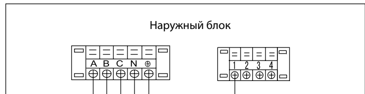
компрессор и двигатель вентилятора вкл./выкл. 220 В
