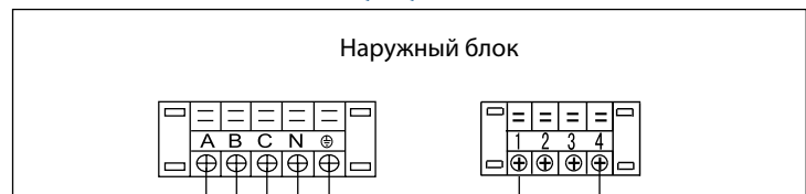
компрессор и двигатель вентилятора вкл./выкл. 220 В
