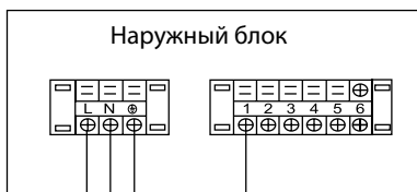
компрессор и двигатель вентилятора вкл./выкл. 220 В
